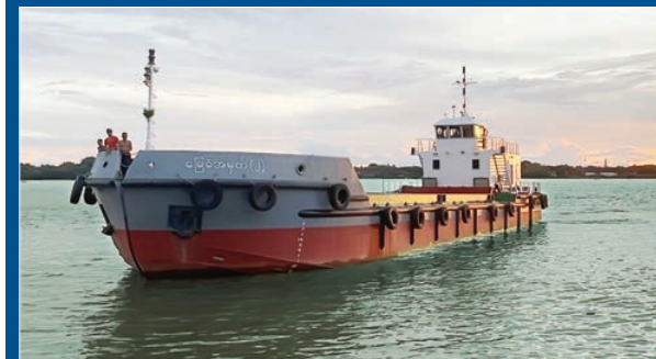
မြေခံ(၂)ရေယာဉ် (250m3 Split Hopper Barge)
