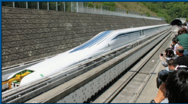
၂၀၁၅ ခုနှစ်တွင် Yamanashi ဌာန 603 km/h နှုန်းဖြင့် စမ်းသပ်ပြေးဆွဲခဲ့ သော L0 Series Maglev ရထားပုံ
